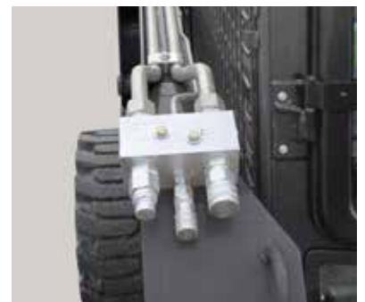
EHF (Enhanced High Flow) 280 bar의 유압을 제공하여 대형 부착물(대형 파쇄기, 회전식 작동 부착물 등) 사용시 작업능률을 대폭 향상 시켜 줍니다. 2차 보조유압 회로를 제공함으로써 복합동작이 요구되는 부착물을 사용할 수 있습니다.
