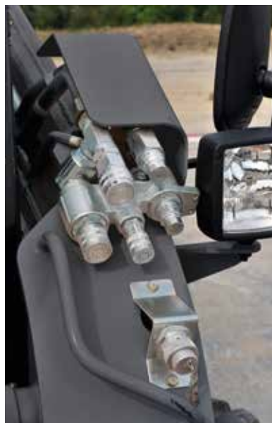
하이 플로우 (High Flow) 추가 보조유량을 공급하여 파쇄기 등의 부착물을 사용할 수 있습니다.
