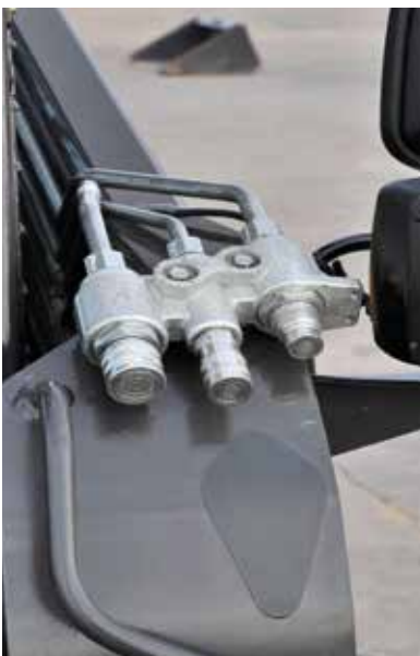
스탠다드 플로우 (Standard Flow) 표준사양의 각종 유압 부착물을 사용할 수 있습니다.
